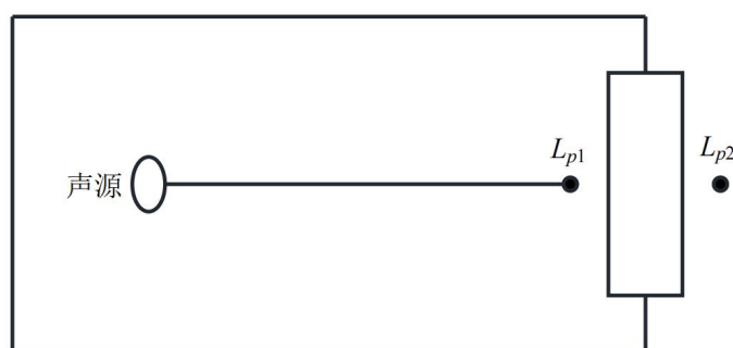
图 4.3-1 室内声源等效为室外声源图例
